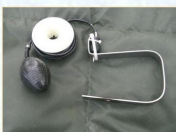
Il faut positionner l'appareil pour que la tige en métal soit quelque millimètres au dessus du déclencheur de prise de vue de l'appareil photo. On fait ensuite le trou inférieur qui servira à **fixer en même temps l'appareil et le support déclencheur** sur le pied :
