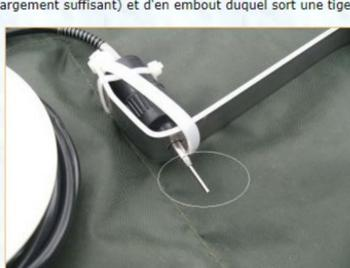
J'ai acheté un plat laminé en acier. Il faut le prendre le plus fin possible car les vis de fixation des pieds d'appareil photo ne sont généralement pas très longues.
